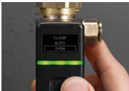
Das Hauptmenü: schließt und öffnet das Ventil und startet den Automatikbetrieb.
